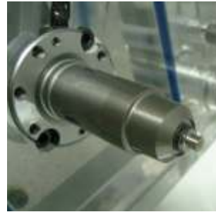
Abb. 4: PM-Nadelführung LA im eingebauten Zustand/ Fig 4: LA variant of the PM needle guide when installed
